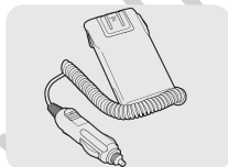
Éliminateur de batterie réf. TLB-428-EL Vous pouvez poser cet accessoire à la place de la batterie et connecter l'émetteur-récepteur directement à une source d'alimentation de voiture (tension d'entrée max. de 13,8 volts).
